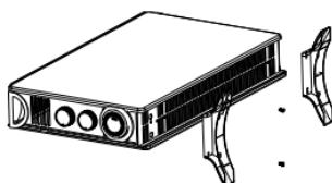
2. Quite los cuatro tornillos autorroscantes del paquete de tornillos y fije el pie a la parte inferior. Una vez instaladas las patas, colocar el convector en vertical.
